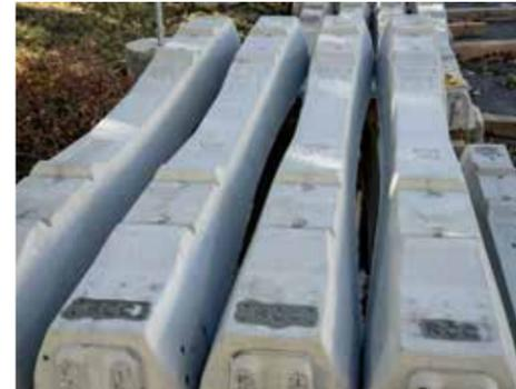
Aus Alt wird Neu: Vigier Rail in Müntschemier verwendet Betonbruch aus alten Schwellen als Kiesersatz bei der Herstellung von Recycling-Betonschwellen.
