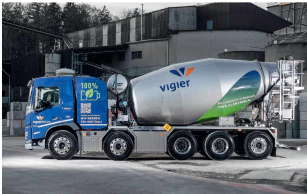
Décarbonation: L'électrification de la flotte de véhicules y contribue également. Ici un camion à bétonnière électrique.
